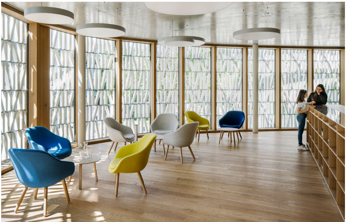
Der ovale Glaspavillon der Stadtbibliothek Dornbirn von Dietrich | Untertriffler ist eingehüllt in eine Struktur aus 8000 vorgefertigten Keramikelementen. Vertikal und schräg angeordnet, erinnern die Sonnenschutz-Ornamente an Bücherregale und sorgen für einen angenehmen Lichteinfall in den Räumlichkeiten.
