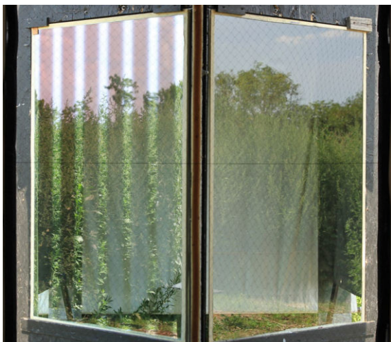
Sicht des Vogels im Versuchstunnel. Pilkington AviSafe™ Aussenansicht: als Schutz vor Vogelanzprall hoch wirksam, vom Innenraum aus kaum sichtbar (links Prüf-, rechts Referenzscheibe).
