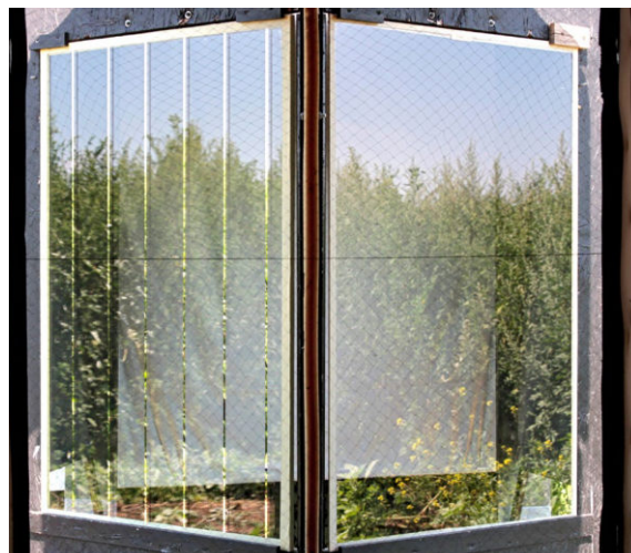
Arnold Glas Ornilux® design lines 5/95: hoch wirksame Metallmarkierung mit klassischem Streifenmuster (links Prüf-, rechts Referenzscheibe).
